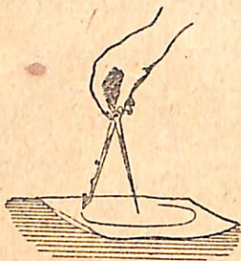
Fig. 289. — Modo de traçar uma circumferencia sobre papel.
