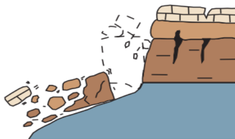
Figura 14: Desenho esquemático para representação da queda de bloco e seus aspectos para identificação em campo. Fonte: Reis (2015).
