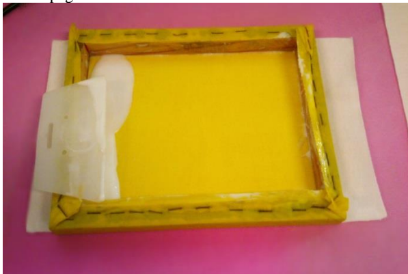
Figura 36 – Estampagem da amostra de meia-malha de PES.
