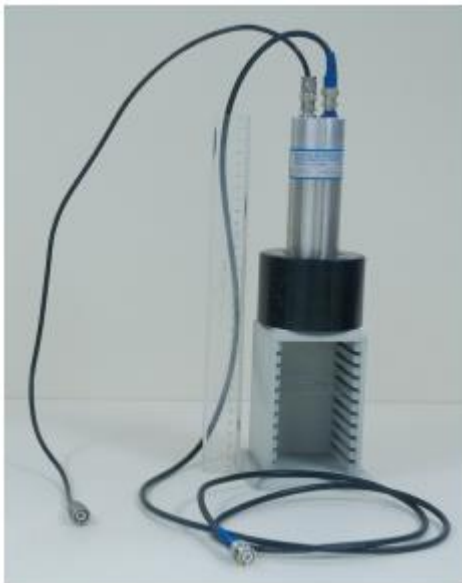
Figura 5: Detector de um espectrômetro de fótons. Fonte: Silva, 2010, p.92.
