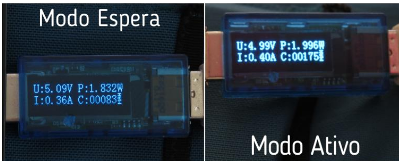
Figura 40 — Medição de consumo energético do dispositivo em modo espera e modo ativo.
