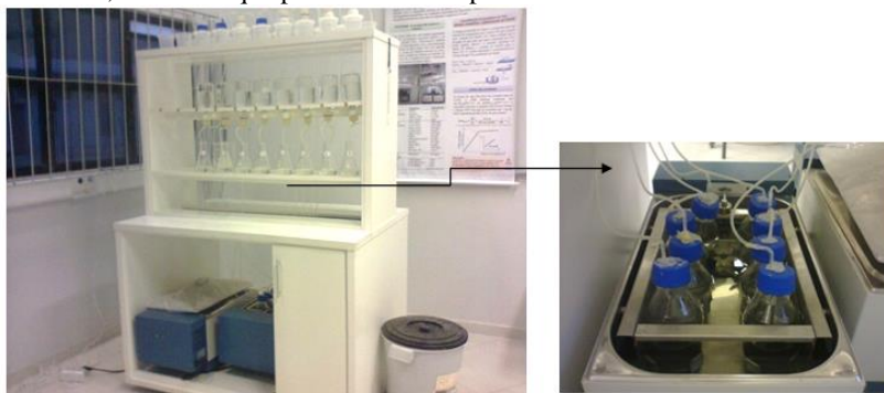
Figura 8- Aparato experimental utilizado no ensaio de biodegradabilidade anaeróbia, com destaque para os frascos tipo Kolbe.
