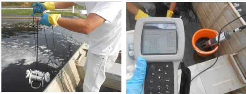
Figura 10 - Garrafa de Van Dorn e sonda multiparâmetros.
