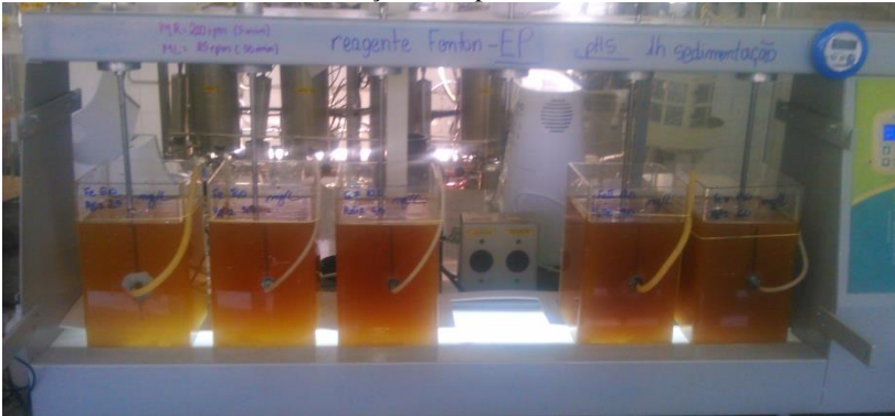
Figura 37 – Variação da cor aparente para o efluente D_{ht} , resultante do tratamento com Reagente Fenton – Fe (II): FeSO_4 \cdot 7H_2O para diferentes concentrações, em pH 5.
