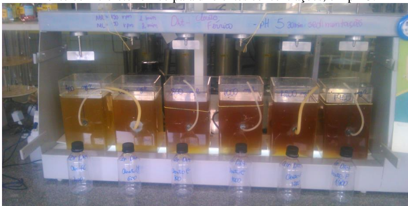
Figura 27 – Variação da cor aparente para o efluente D_{ht} , resultante do tratamento com cloreto férrico para diferentes concentrações, em pH 5.
