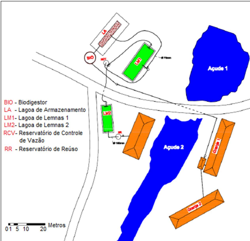
Figura 17. Croqui do sistema de tratamento na propriedade.
