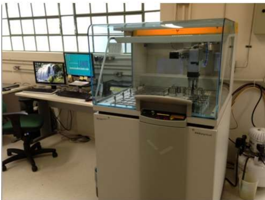
Figura 3: Equipamento de fluorescência raios-X ( Axios ) utilizado na análise das amostras (fonte: LAMIR/UFPR).
