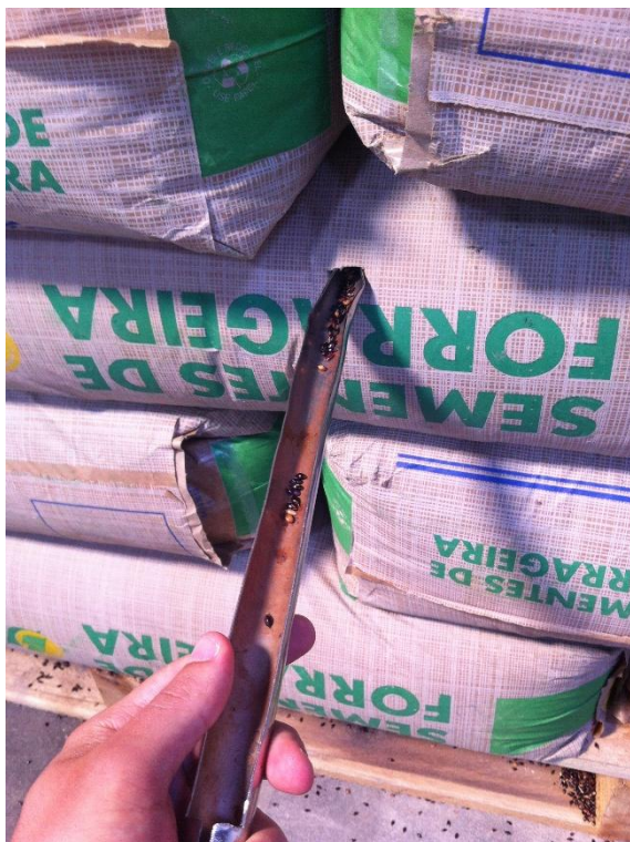
Figura 8. Amostragem em sacos de sementes de capim sudão com auxílio de um calador do tipo simples.
