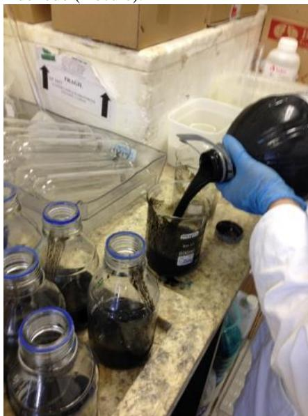
Após a preparação dos reatores com inóculo e substratos nas devidas proporções, colocou-se a tampa de borracha (Figura 22) com dois tubos de metal e a haste de agitação conectada (Figura 24) na abertura de cada garrafa e posicionou-se a rosca/suporte do motor de plástico (Figura 23). Apertou-se até que a rosca na garrafa não fosse mais visível e a tampa estivesse devidamente enroscada.
