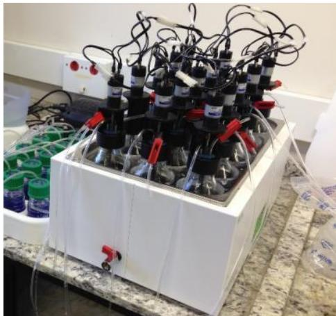
Por último instalou-se o dispositivo de medição de biogás, que foi preenchido com água destilada, dentro dos limites da marcação localizada na parede lateral interna do banho (Figura 26) e em seguida circulou-se um fluxo de  $N_2$  nas amostras, para garantir o meio anaeróbio dentro dos reatores.
