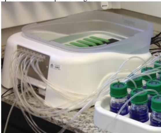
A partir da conclusão de todas as etapas necessárias ao início do ensaio, foi dada partida ao banho Maria (Figura 27), sob  $35^{\circ}C$ , e iniciado o registro da geração, através do software AMPTS II, utilizado na aquisição e registro dos dados.
