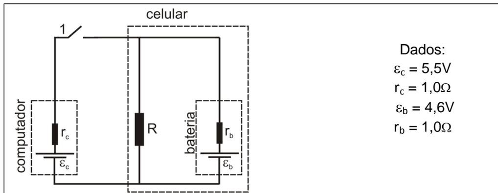
Observação: a tensão de saída da porta USB deste computador é  $V_c = \varepsilon_c - i.r_c = 5,0V$  e a corrente máxima é de 500,0 mA.
