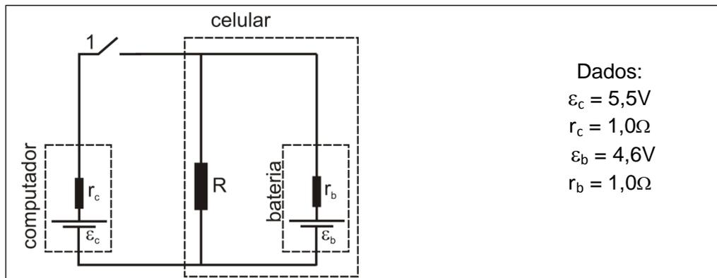
Observação: a tensão de saída da porta USB deste computador é  $V_c = \varepsilon_c - i \cdot r_c = 5,0V$  e a corrente máxima é de 500,0 mA.
