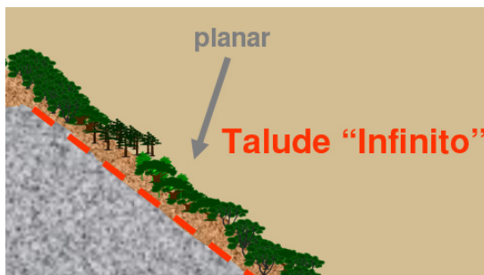
Figura 67. Demonstração gráfica de um talude infinito. Fonte: Adaptado Marinho (2010).
