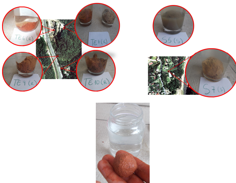
Figura 39. Moldagem de esferas submetidas à imersão para determinação da transição entre solos residuais e sedimentares da microbacia de estudo.
