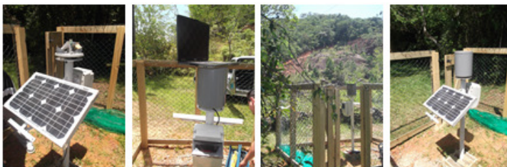
Figura 55. Imagem da montagem final do pluvimetro.
