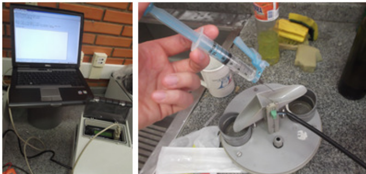
Figura 54. Imagem do processo de calibração do pluvimetro.
