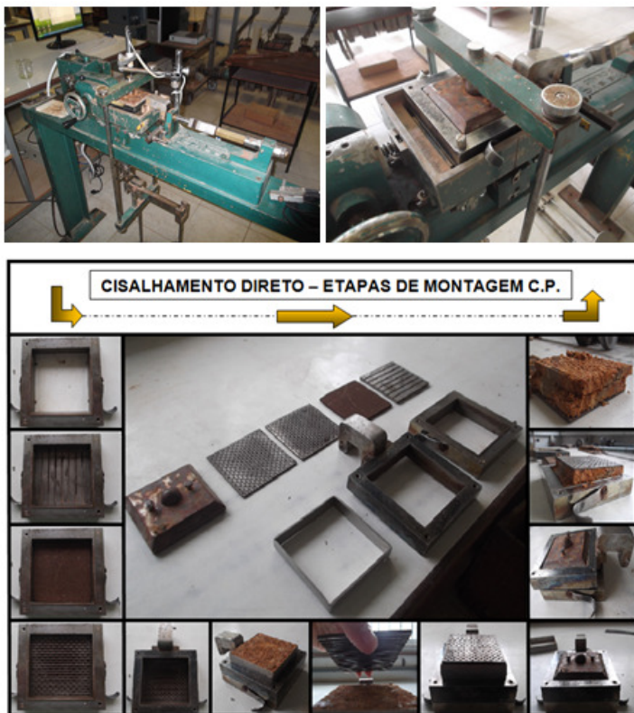
Figura 61. Preparação e execução do ensaio de cisalhamento direto.
