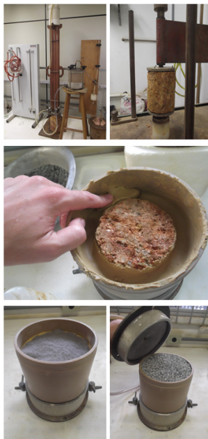
Figura 62. Preparação da amostra e realização do ensaio de permeabilidade de carga variável.
