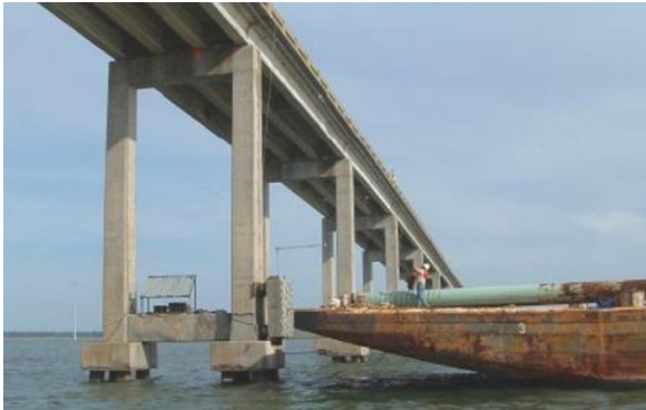
Figura 3.24 – Execução dos impactos Fonte: Ferraro, Boyd, Consolazio (2013)
