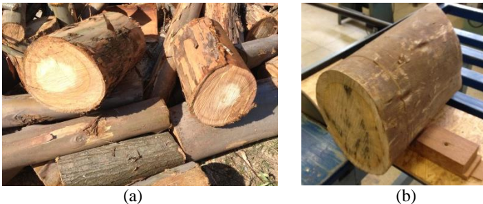
Figura 7.16 – Toras utilizadas no ensaio (a) abatimento em campo (b) confecção em discos
