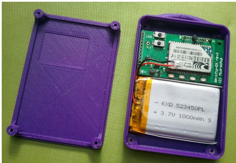
Figura 14: Hardware do Crachá WiFi.
