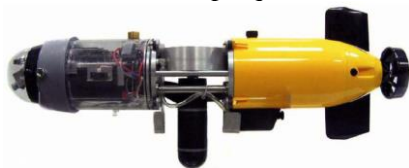
Figura 1.1: Exemplo de AUV comercial do tipo torpedo e com um propulsor (BRÄUNL, 2008)
