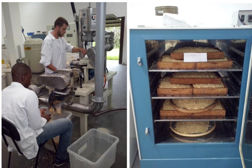
Figura 1. Extrusão das dietas e secagem em estufa com circulação forçada.
