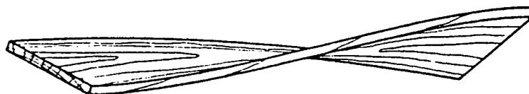
**Figura 4.6** - Torção da peça de madeira.
