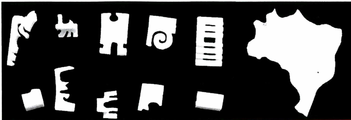
Figura 30 - Peças usinadas manualmente na Máquina Beta.
