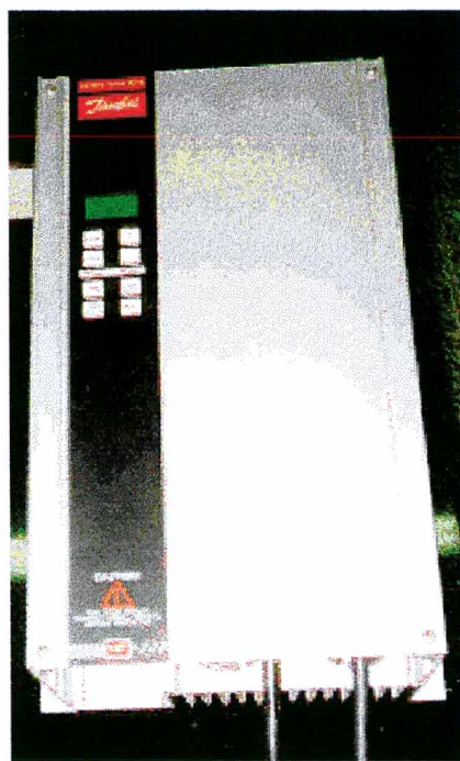
Figura 10 - Variador de frequência adaptado à Máquina Beta.
