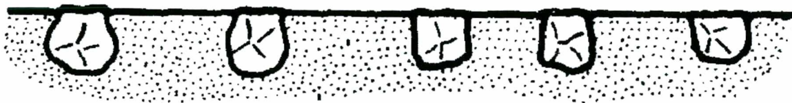
Figura 17 - Evolução do desgaste de uma ferramenta diamantada com ligante muito duro.
