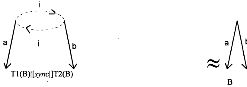
Figura 3.11 - Funcionamento do mecanismo de polling (convite seletivo alternado).
