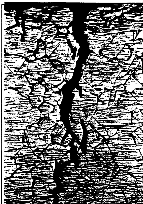
FOTO 3.14 - Trinca de corrosão sob tensão no metal de base AISI 304. Amostra W3. Ataque ácido oxálico 10%. Aumento 200x.
