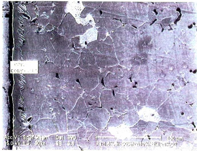
Fig. 26(b) - Amostra nitretada ( $N_2 - H_2 - O_2$  )
