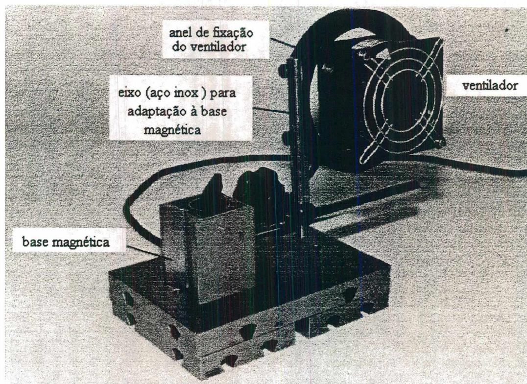
**Figura 3.20-** Sistema de ventilação forçada.
