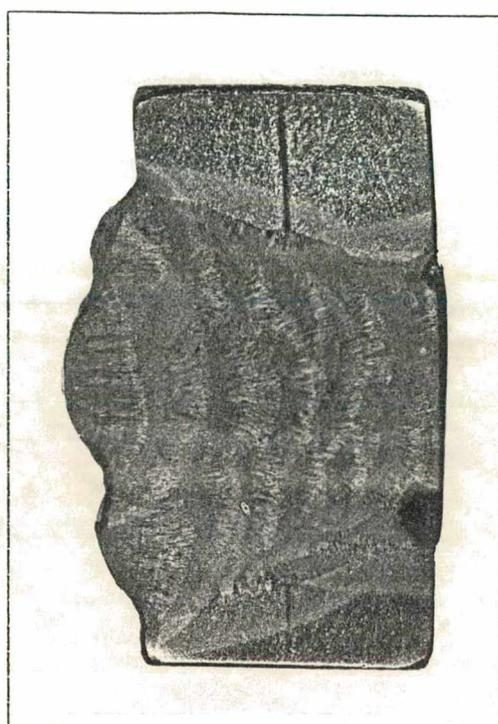
Figura 66 - Macrografia (eletrodo B - CA) 100 X
