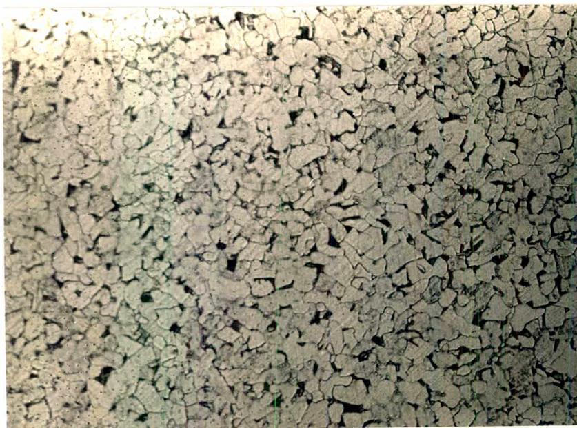
FIGURA 4.20 - Microestrutura do aço 1.
