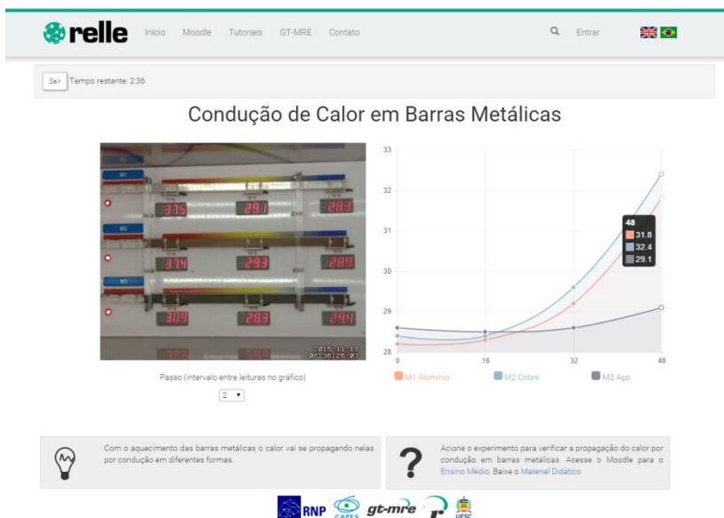
Figura 28 - Experimento Condução de Calor em Barras Metálicas
