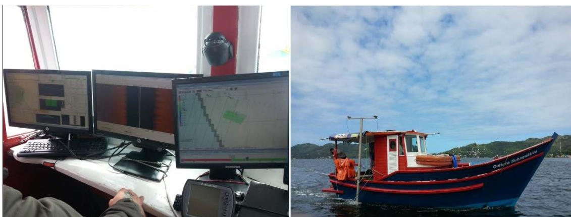
Figura 14. Imagem da central de controle da batimetria, sonografia e navegação (à esquerda) e do sonar Edgetech 4600 instalado na lateral da embarcação através de uma estrutura fixa (à direita).
