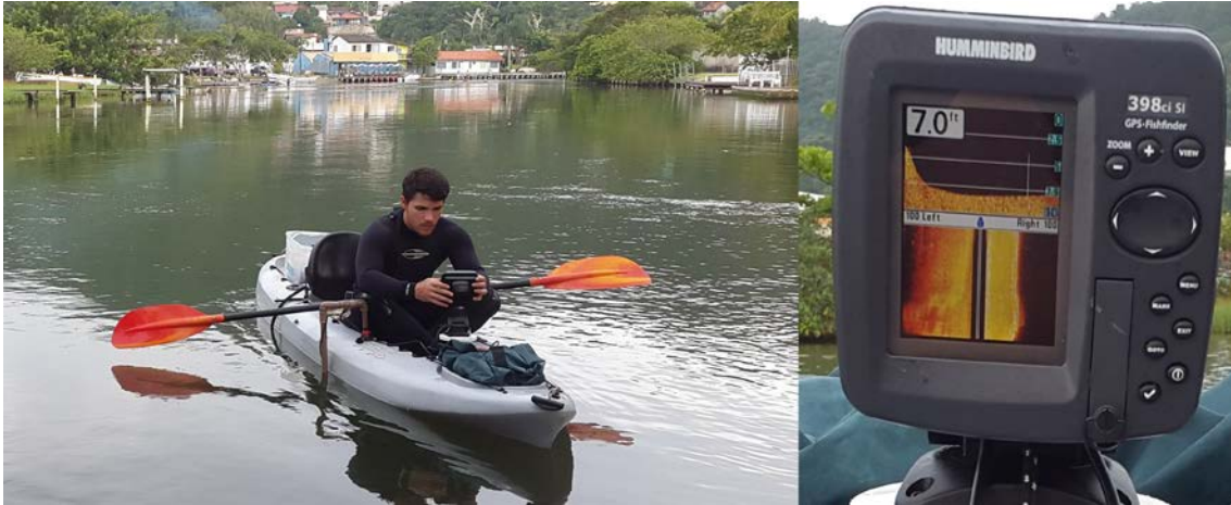
Figura 20. Caiaque e sonar Humminbird 398 Ci Si utilizados na localização dos alvos selecionados para registro fotográfico.
