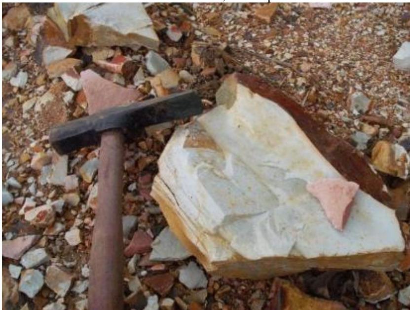
Figura 9 – Detalhe de fragmentos de rocha retirados de corte de exploração de cascalho de argilito em elevação residual localizada na Linha 14 de Julho, município de Nova Veneza.
