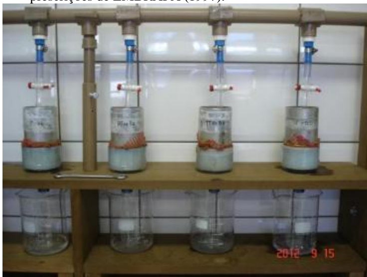
Figura 15 – Equipamento construído para determinação da condutividade hidráulica, usando cilindros do trado Uhland, conforme prescrições de EMBRAPA (1997).
