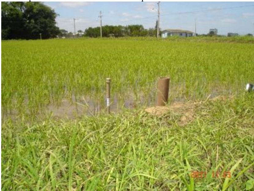
Figura 14 – Fotografia do Ponto amostral P01 mostrando a disposição do piezômetro e do tensiômetro na quadra de arroz.
