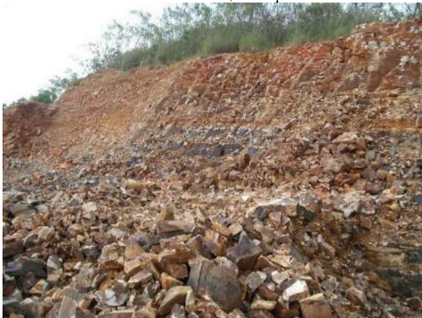
Figura 8 – Corte de exploração de cascalho de argilito, provavelmente pertencente à Formação Estrada Nova, em elevação residual localizada na Linha 14 de Julho, município de Nova Veneza.
