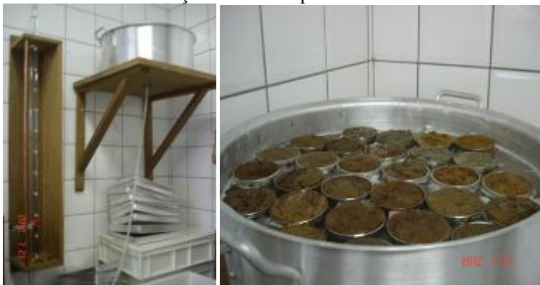
Figura 16 – Mesa de tensão segundo modelo de Lima e Silva (2008) e amostras indeformadas acondicionadas para determinação da umidade em função da tensão aplicada.
