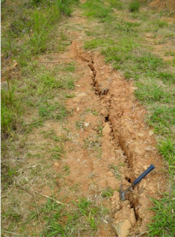
Prancha 12 Autora,2013. Degráus e trincas em depósito coluvial em área deslizada
