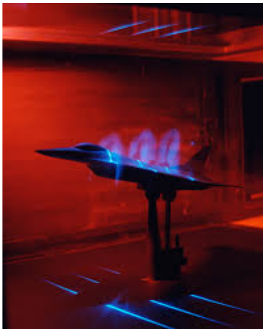
Figura 5 – Escoamento em torno da superfície de um objeto utilizando o método feixe de laser.
