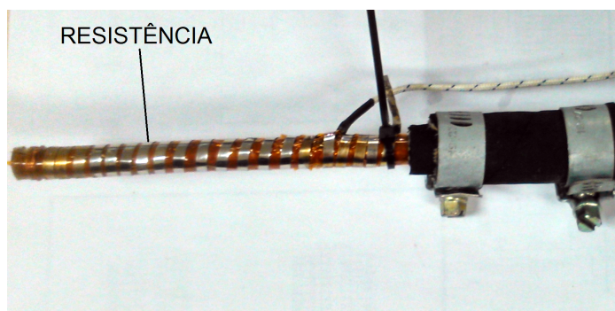
Figura 11 – Estrutura de aquecimento do fluido.
