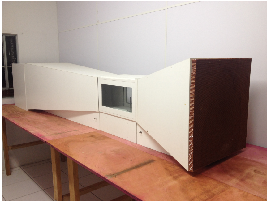
Figura 1 – Túnel de vento didático da UFSC - campus Joinville.
