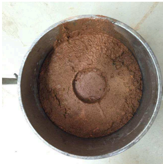
Figura 28 - Corpo de prova após penetração do pistão
