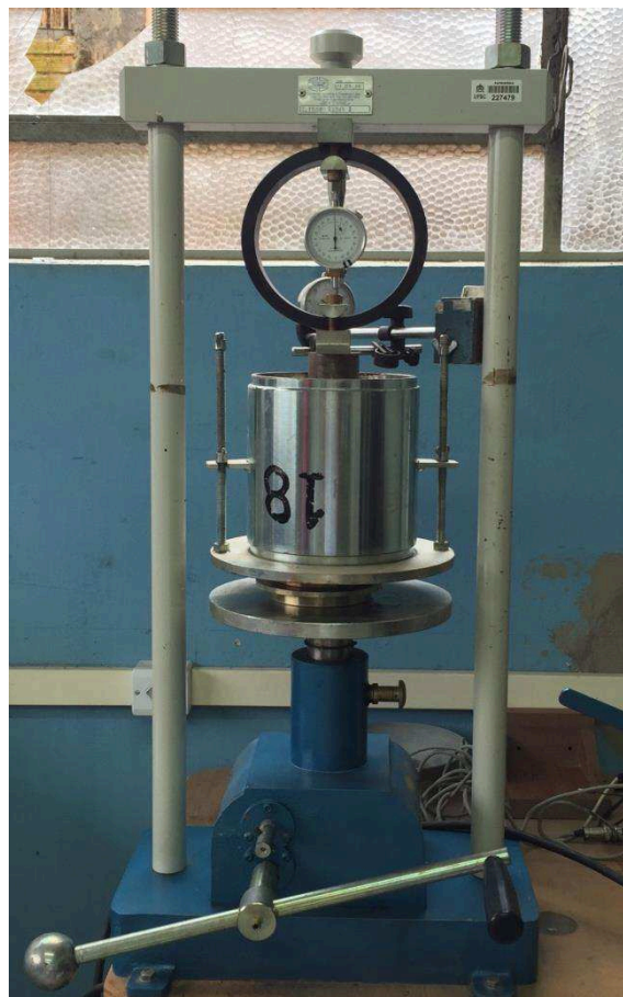
Figura 27 – Ensaio de CBR
