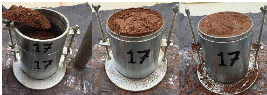
Figura 24 – Inserção de solo para compactação (a), desmonte do equipamento (b) e arrasamento (c)
