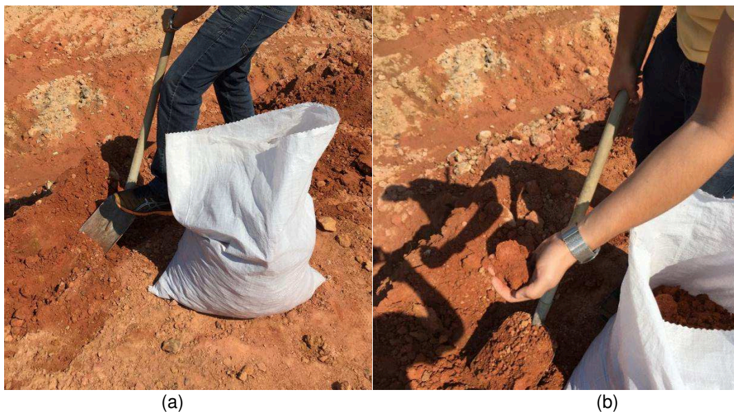
Figura 7 - Coleta (a) e análise tátil visual (b)
