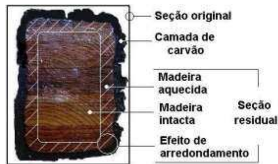
Figura 2 – Seção de uma viga de madeira exposta ao fogo durante 30 minutos. Fonte: http://www.cdcc.sc.usp.br/ciencia/artigos/art_27/madeira.html
