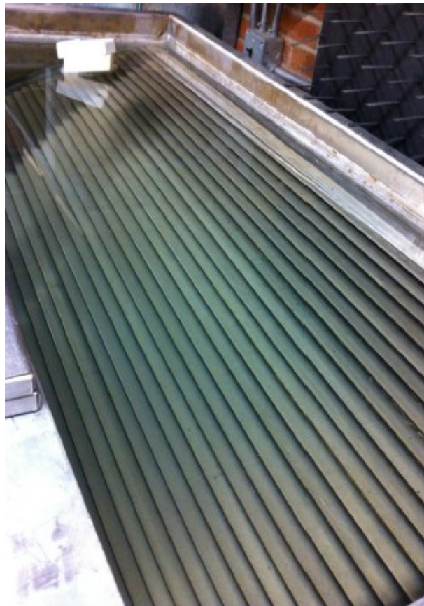
Figura 16 – Foto das aletas direcionadoras de fluxo do canal de água circulante da Universidade de Alberta, Canadá.
