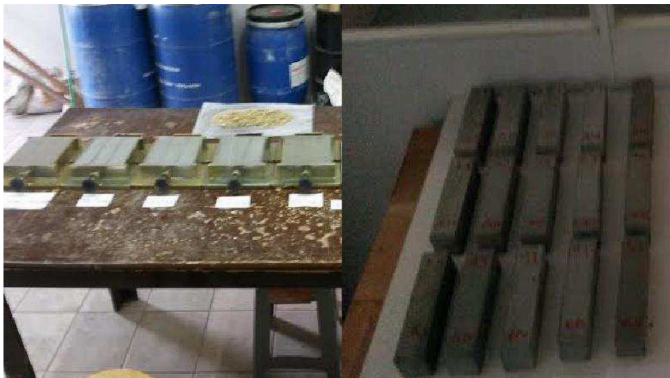
Figura 4 - Corpos de prova utilizados para o ensaio de compressão.
