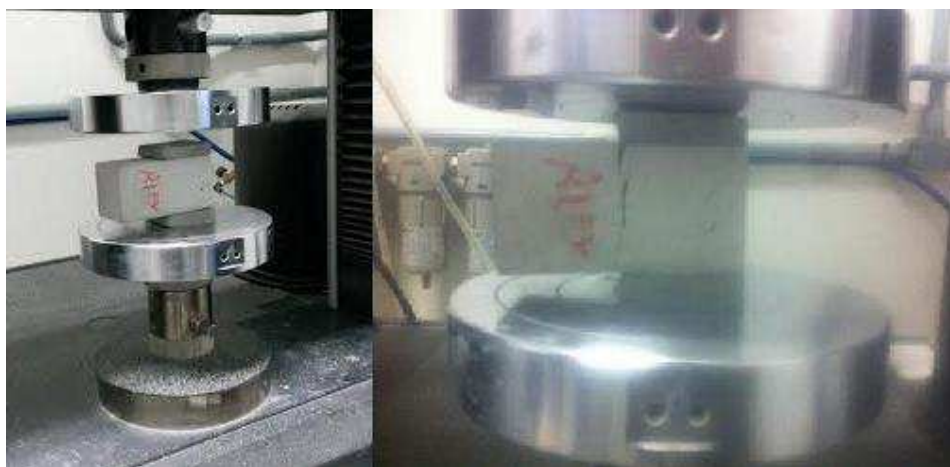
Figura 5 - Ensaio de compressão das argamassas aos 28 dias de cura.
