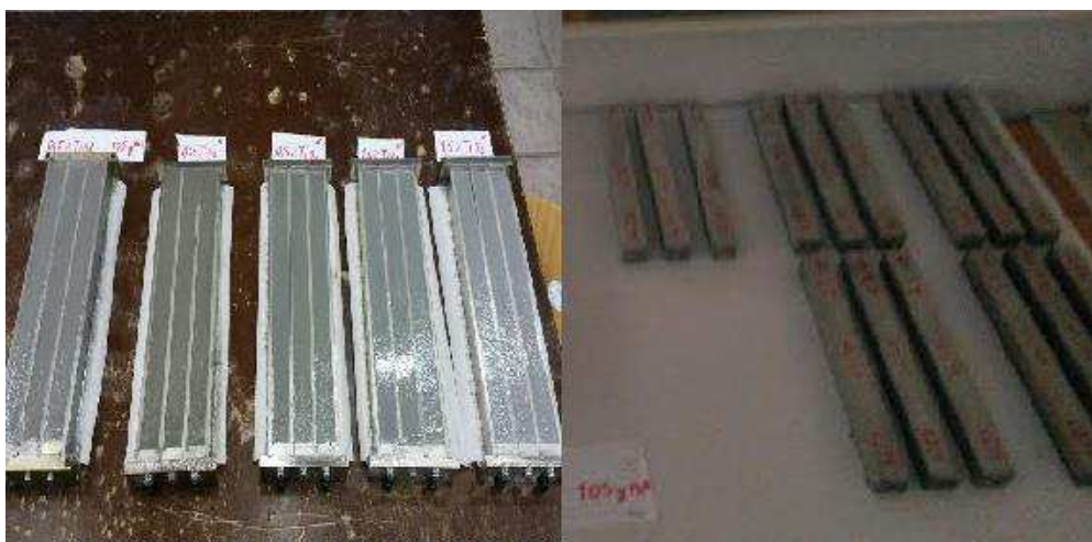
Figura 6 - Corpos de prova utilizados no ensaio de retração.
