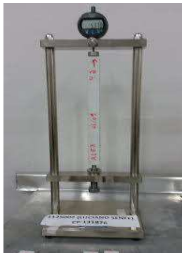
Figura 7 - Aparelho usado para medir a retração das argamassas.
