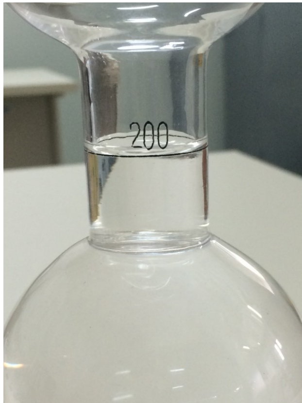
Figura 5.26 – Leitura de água antes do início do ensaio.
