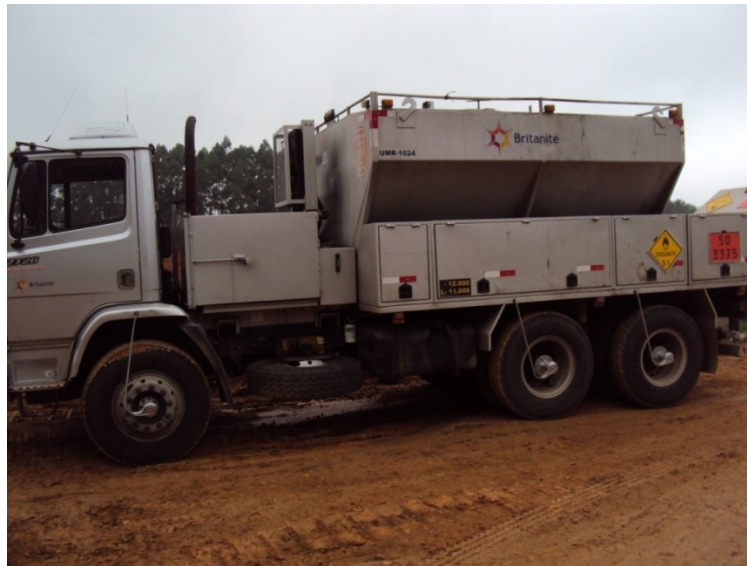
Figura 4.5 – Caminhão tanque para o transporte da emulsão bombeável.
