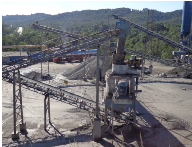
Figura 4.17 – Britador de impacto vertical da empresa Fortunato.
