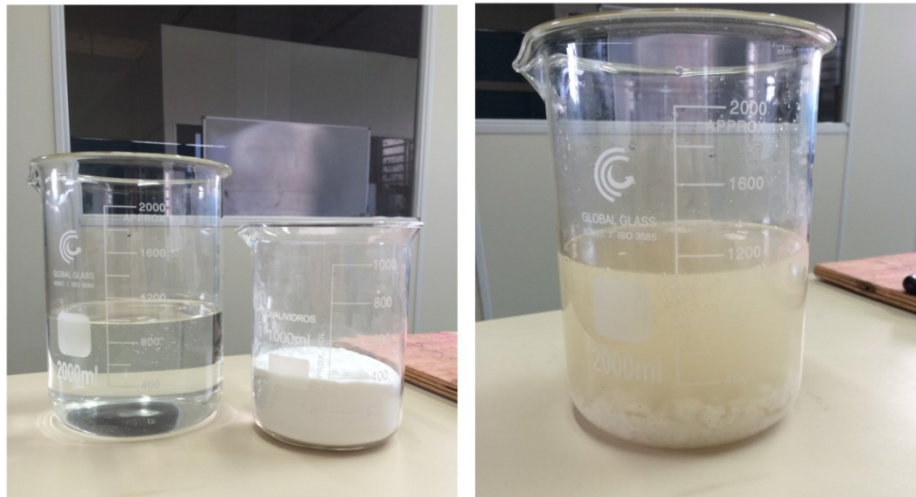
Figura – 5.14 – Solução de sulfato de sódio: (a) 1 litro de água e 500g de sulfato de sódio; (b) Solução pronta.
