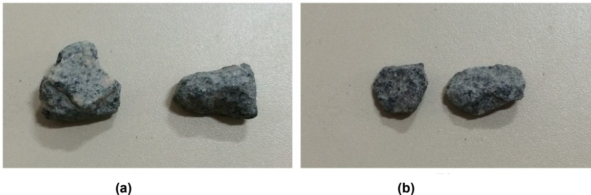
Figura 5.17 – Partículas com formato aproximadamente lamelar (direita) e cúbico (esquerda): (a) fração 19,1 – 12,7 mm; (b) fração 12,7 – 9,5 mm.
