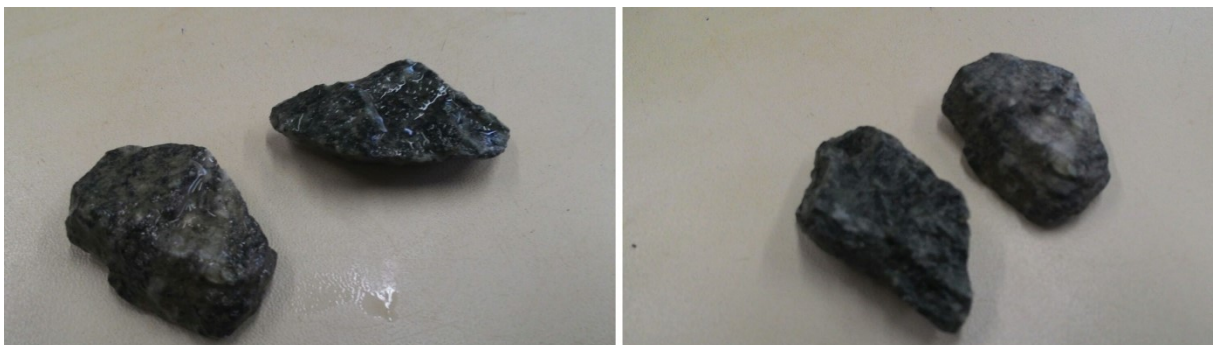
Figura 5.25 – Diferença visual entre: (a) superfície molhada; (b) superfície saturada seca.
