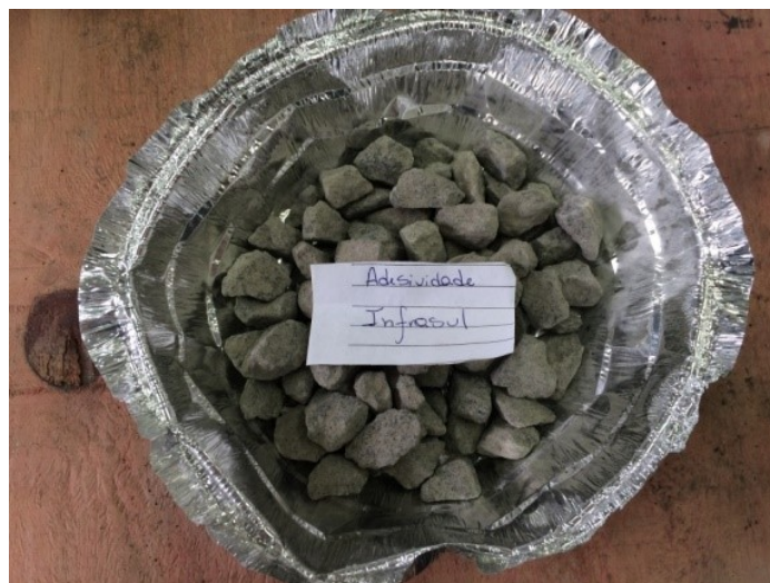
Figura 5.20 – Amostra de adesividade ao ligante betuminoso da jazida Rio Zoada.
