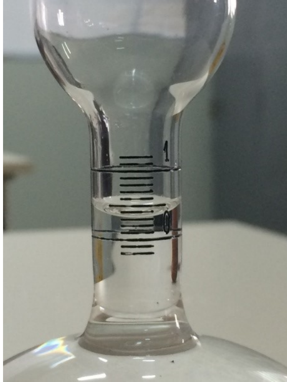
Figura 5.30 – Medida de água no gargalo do frasco Le Chatelier.
