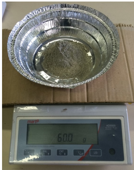
Figura 5.29 – Amostra para o ensaio de massa específica para material finamente pulverizado da jazida Sol Nascente.
