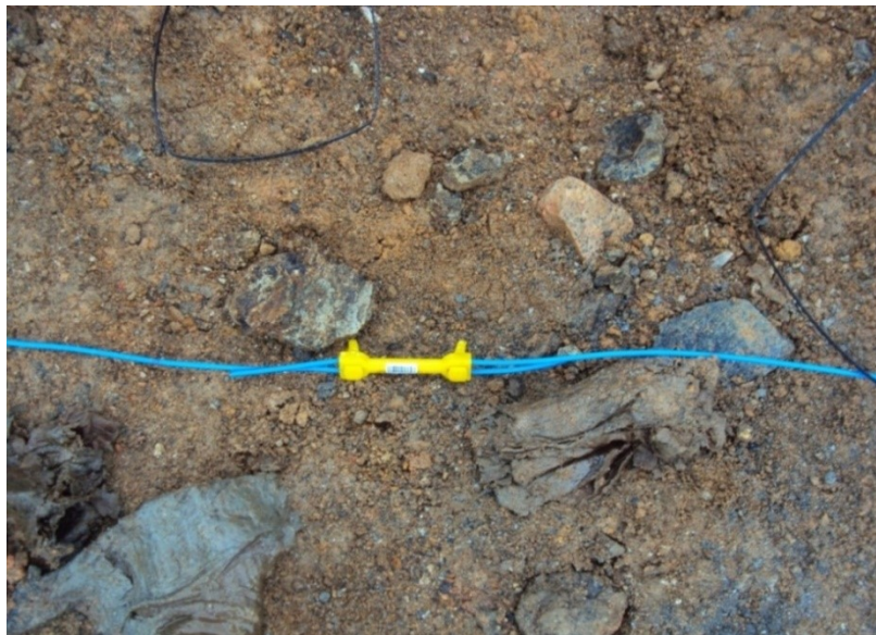
Figura 4.7 – Cordel detonante com a utilização de um retardo de 20 milissegundos.
