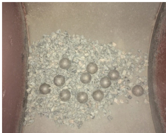
Figura 5.10 – Amostra da jazida Rudnick no interior da máquina Los Angeles juntamente com a carga abrasiva.
