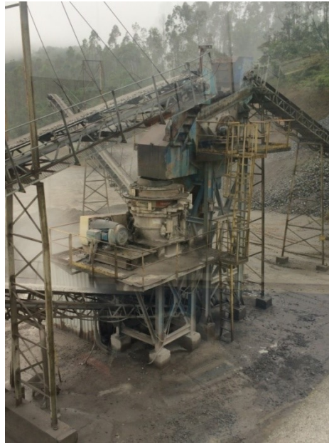
Figura 4.15 – Britador girosférico da empresa Fortunato.
