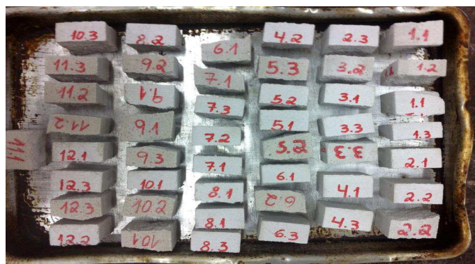
Figura 14: Corpos de prova para ensaios de propriedades físicas
