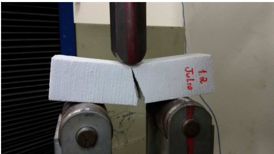
Figura 23: Ensaio de flexão da argamassa de referência
