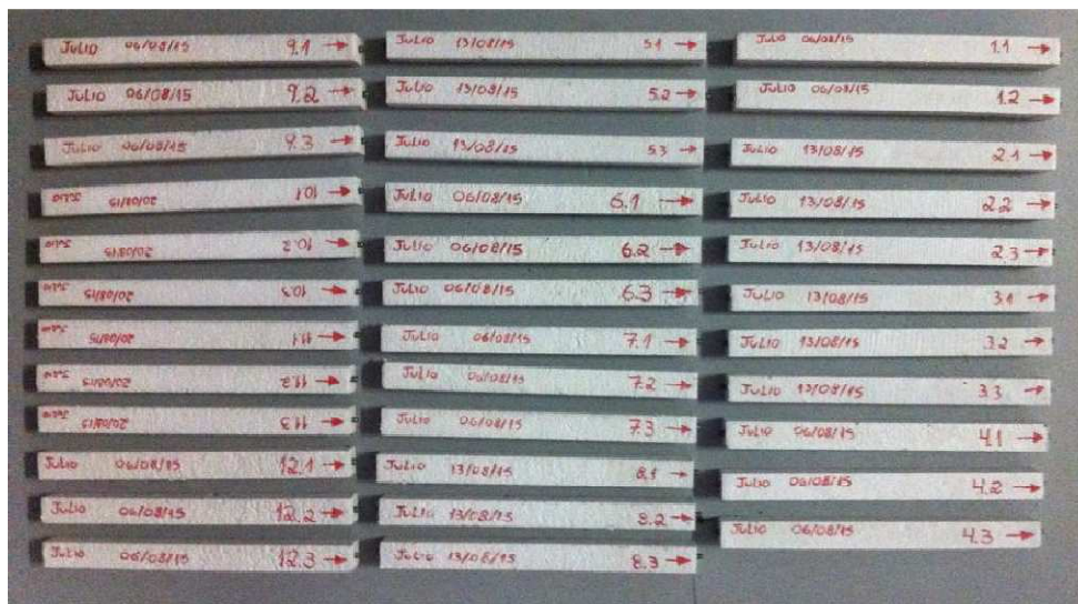
Figura 20: Corpos de prova para ensaio de retração
