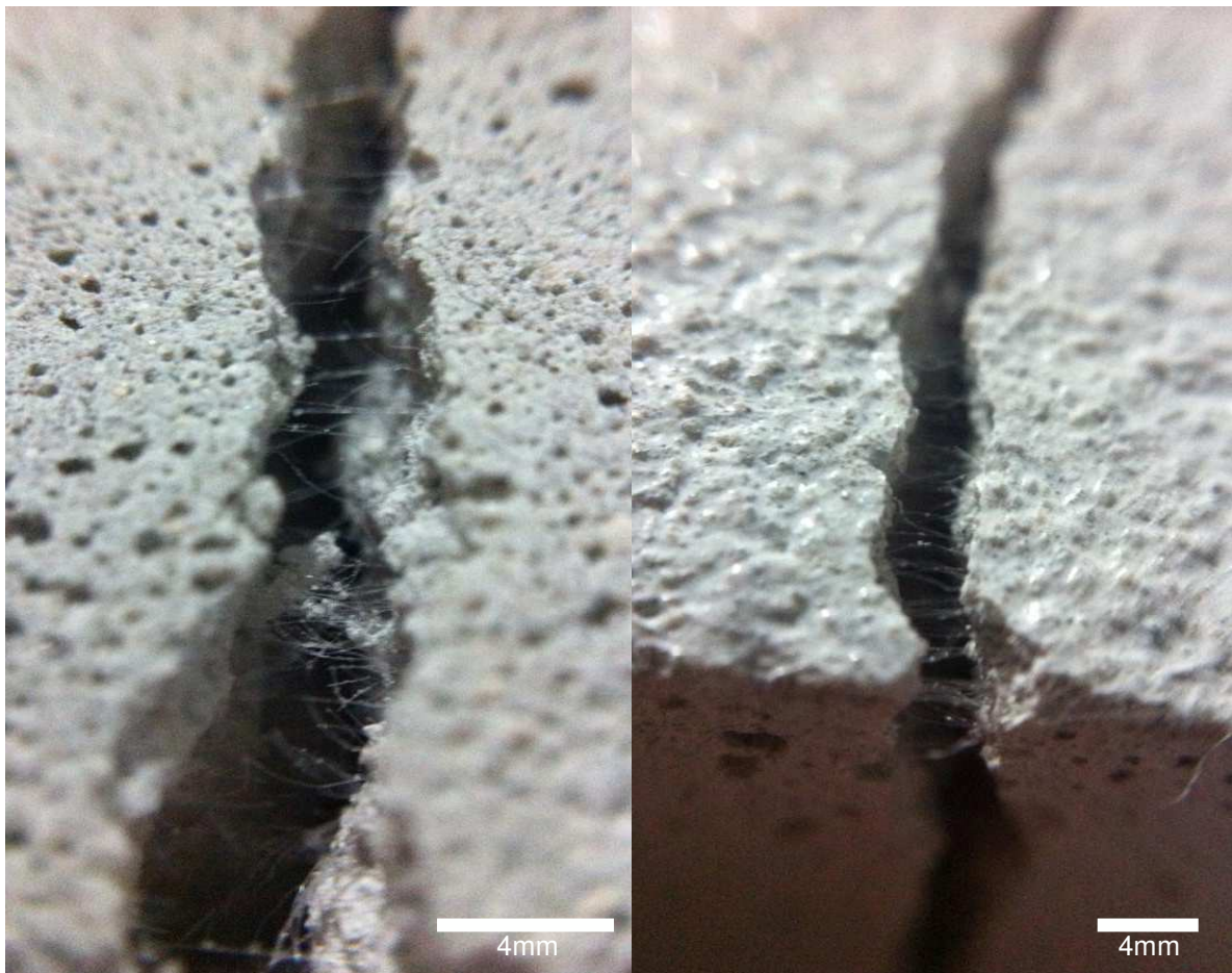
Figura 30: Efeito ponte gerado pela Fb na matriz
