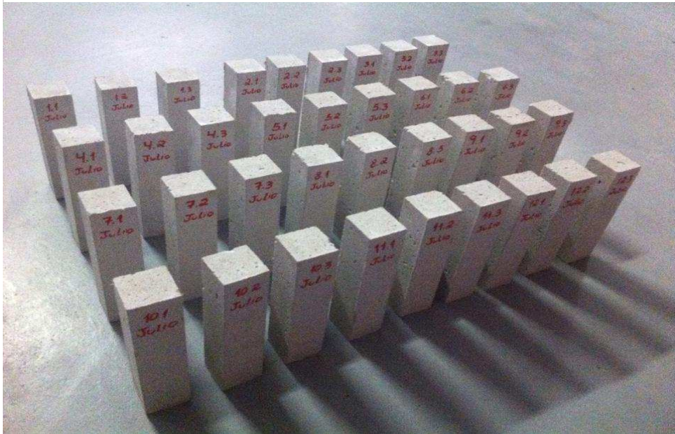
Figura 22: Corpos de prova para ensaio de flexão
