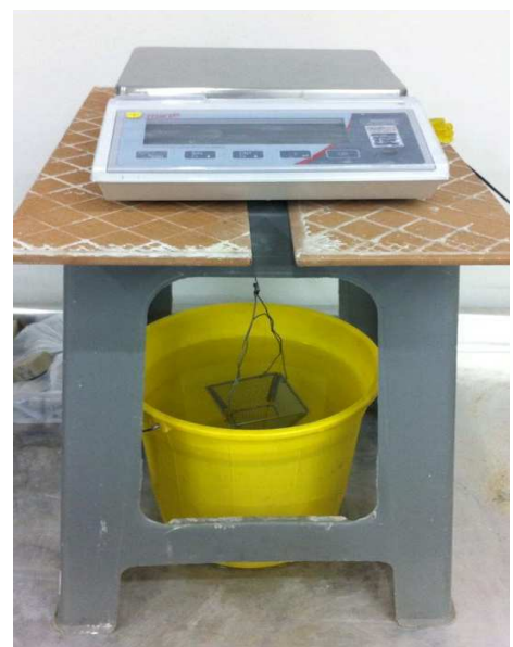
Figura 18: Pesagem de massa imersa
