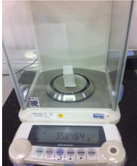
Figura 19: Pesagem de massa saturada de superfície
