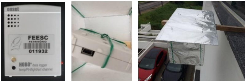
Figura 24 - Datalogger externo (HOBO Onset) e caixa de proteção para uso do equipamento em ambiente externo
