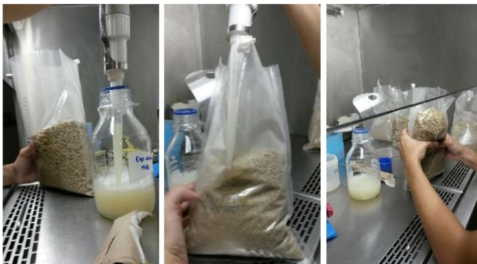
Figura 3 - Processo de adição e mistura do probiótico ou soro estéril nas rações.
