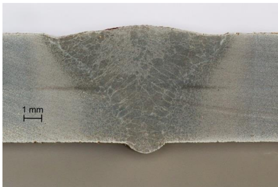
Figura 85 – Macrografia da seção transversal do cordão feito com TIG Keyhole Pulsado.
