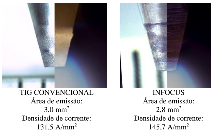
Figura 43 – Medição das áreas de emissão de elétrons e estimativa da densidade de corrente para um arco de soldagem de 400 A e temperatura de resfriamento da tocha de 15° C.
