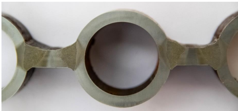
Figura 79 – Juntas tubo-membrana de painéis de caldeira feita através do processo MIG/MAG.
