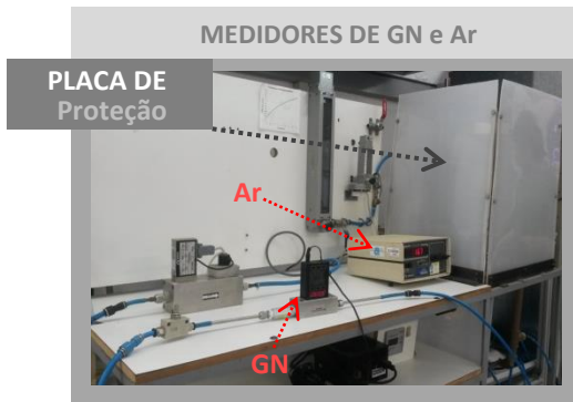
Figura 14: Fotografias mostrando a bancada de testes utilizada.
