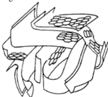
Figura 2. Representação esquemática da estrutura de um carvão ativado. 26
