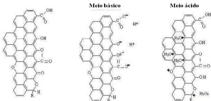
Figura 4. Representação esquemática de alguns grupos ácidos oxigenados (carboxila, hidroxila e lactonas) e o caráter básico do plano basal dos elétrons deslocalizados, e grupos de oxigênio. 27,28
