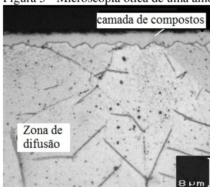
Figura 5 - Microscopia ótica de uma amostra nitrocementada a plasma.
