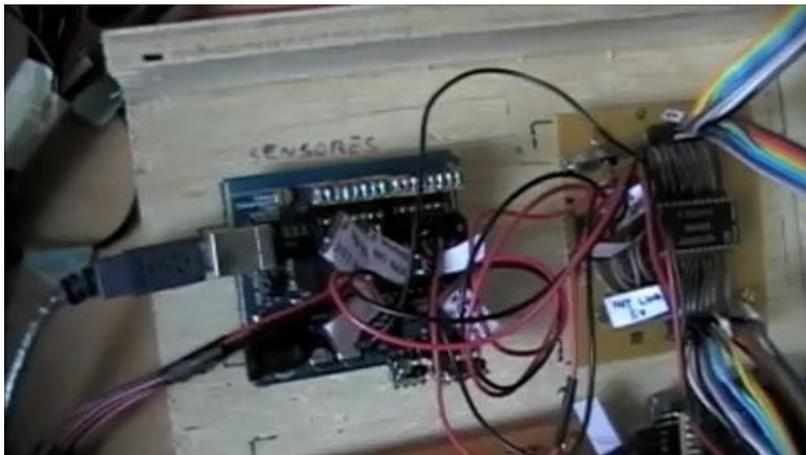
Imagem 03: Placa Arduino e a conexão dos sensores dentro do *Palavrador Open Book 2.0*.
