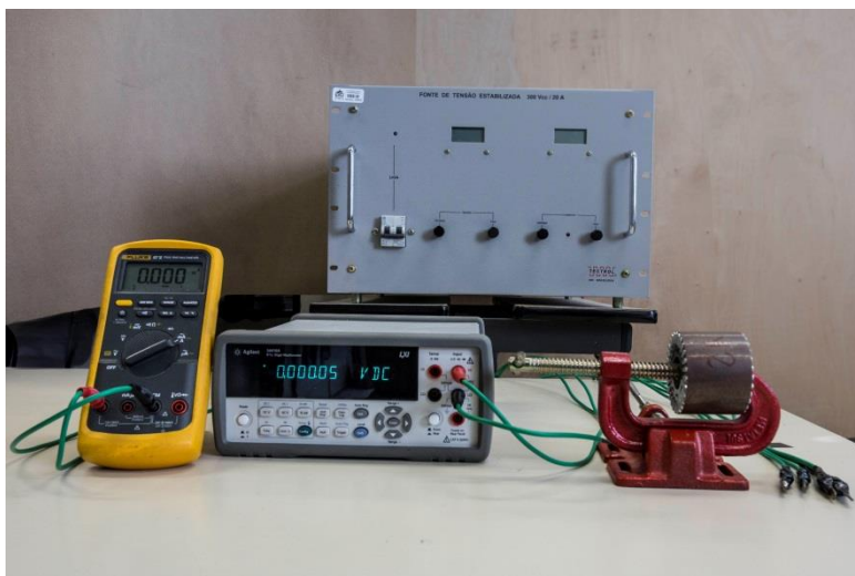
Fig. 5.19 – Instrumentos utilizados para medição da resistência interbarras.
