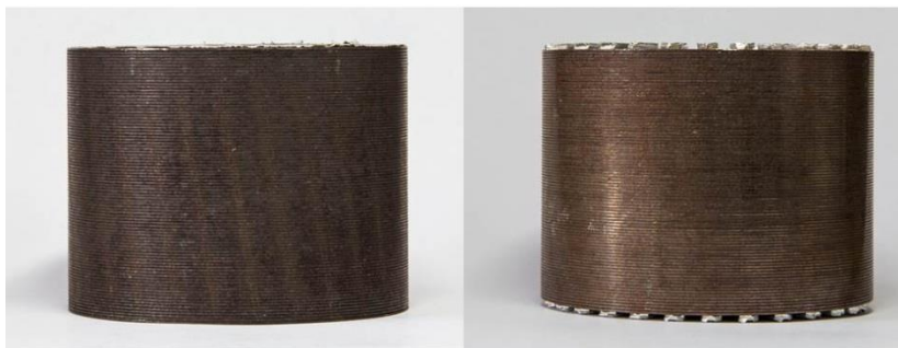
Fig. 5.16 – Perfil dos rotores após a usinagem dos anéis de curto-circuito, antes e depois da retirada de 2 lâminas superiores e inferiores.
