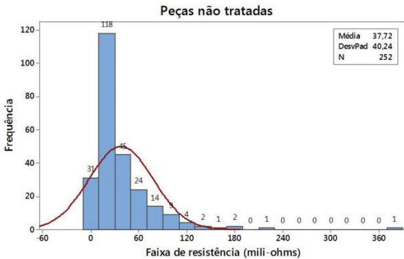
Fig. 5.22 – Histograma de valores de resistência interbarras - Peças não tratadas
