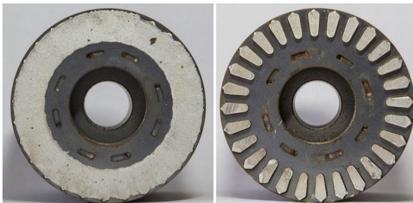
Fig. 5.17 – Vista superior dos rotores antes e depois da retirada de 2 lâminas superiores e inferiores.
