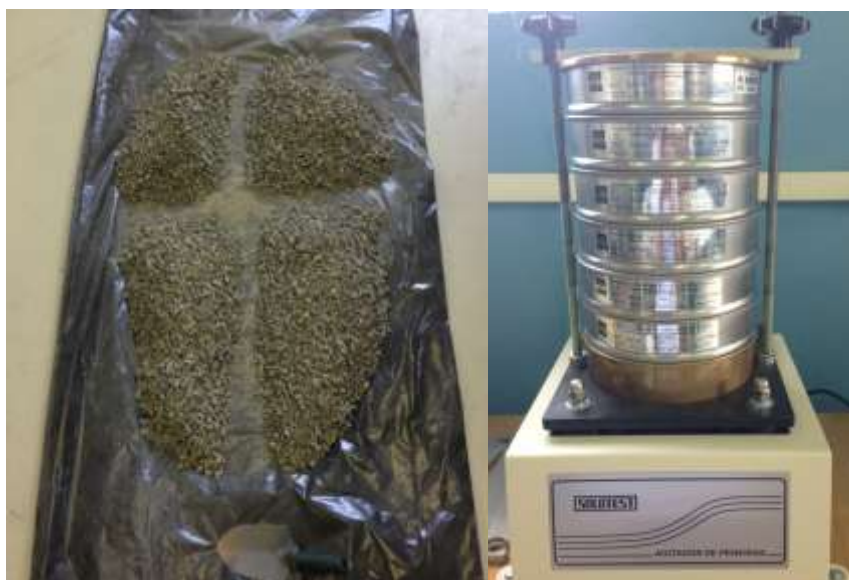
Figura 3.2 - Peneiramento do agregado mineral (a) quarteamento e (b) agitador de peneiras.
