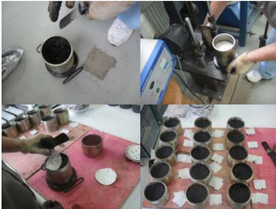
Figura 4.3 - Procedimento para modelagem dos corpos de prova.
