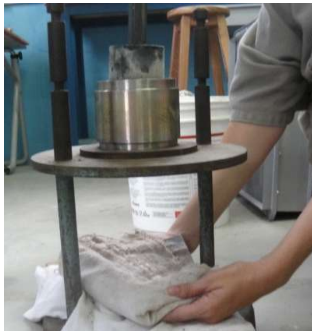
Figura 4.4 - Extração dos corpos de prova.
