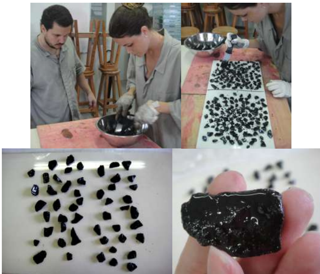
Figura 3.7 – Ensaio de adesividade.
