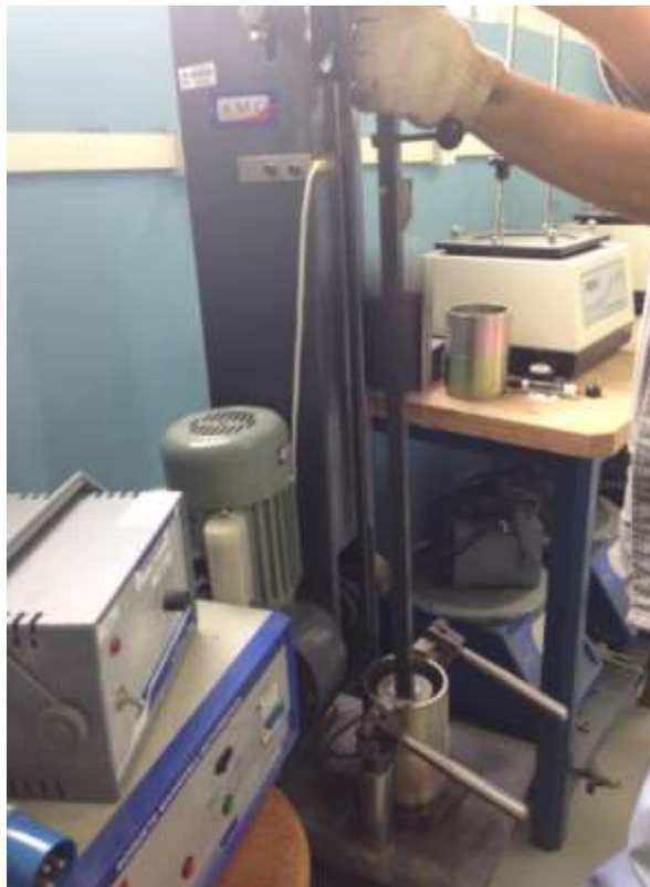
Figura 4.1 - Aparelho de compactação de corpos de prova ensaio Marshall.
