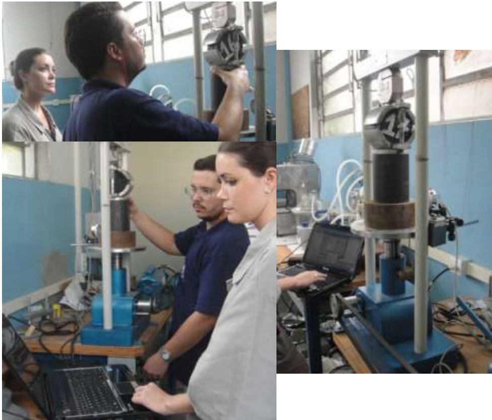
Figura 4.8 - Rompimento dos corpos de prova.
