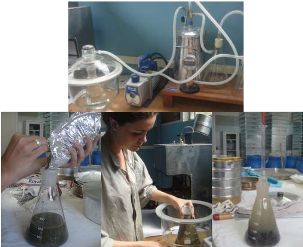
Figura 3.4 – Ensaio de massa específica real do agregado.
