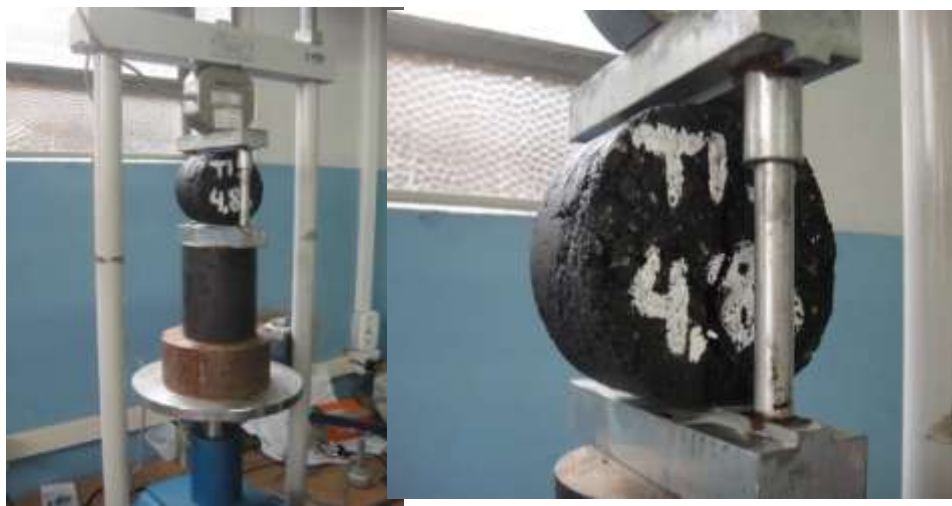
Figura 4.10 - Execução do ensaio de resistência à tração indireta.
