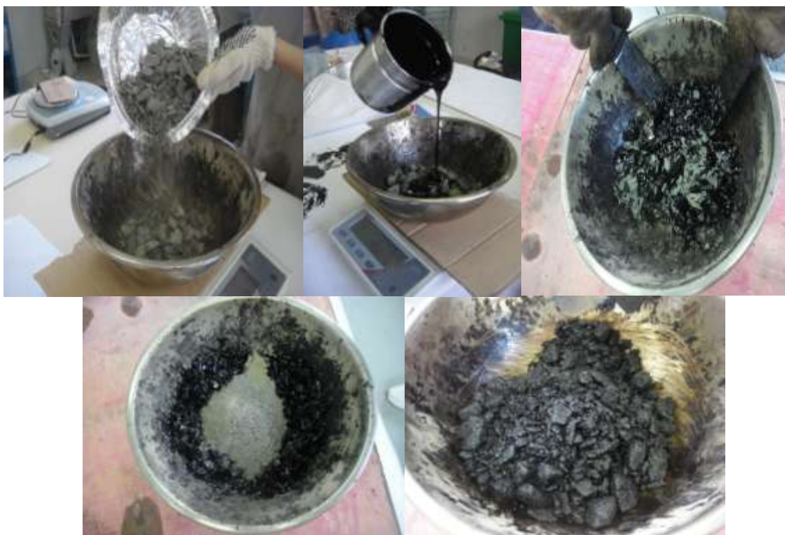
Figura 4.2 - Processo de mistura do esqueleto mineral ao ligante betuminoso.
