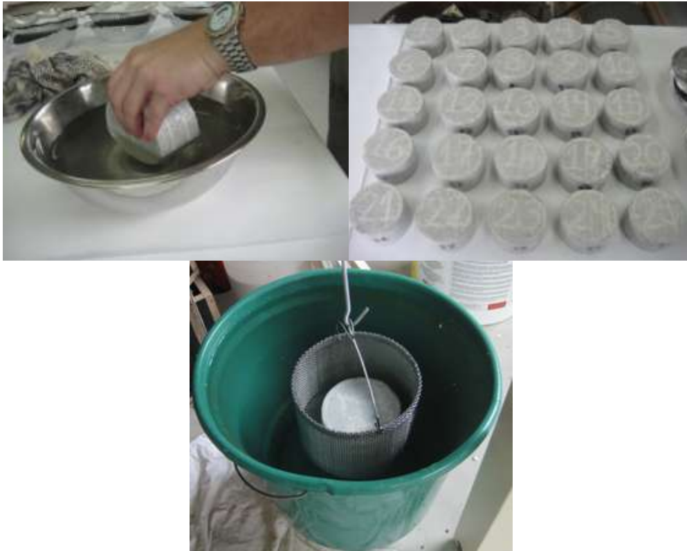
Figura 4.6 - Determinação da massa específica aparente – pesagem hidrostática.
