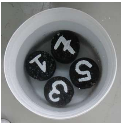
Figura 4.7- Corpos de prova imersos em água.
