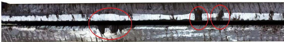
Figura 4.8 – Depressões nos chanfros dos corpos de prova
