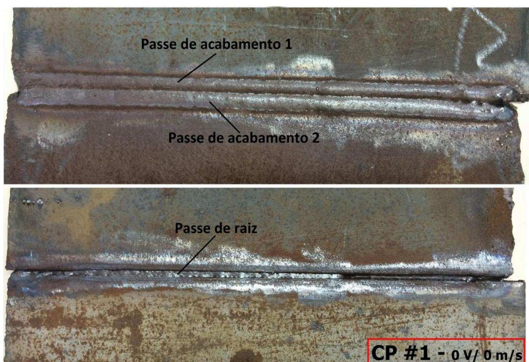
Figura 5.1 – CP1 - Soldas realizadas sem ação dos ventos
