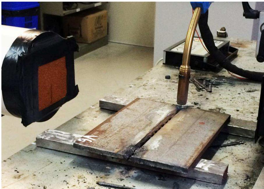
Figura 4.17 – Posicionamento do corpo de prova
