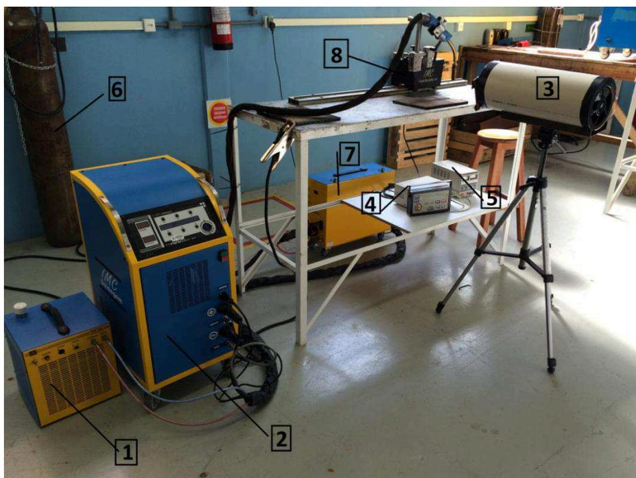
Figura 4.2 – Bancada de Ensaios. (1) Unidade de Refrigeração; (2) Fonte de Soldagem; (3) Gerador de Ventos; (4) Acionador do Sistema de deslocamento automático; (5) Fonte de tensão variável; (6) Cilindro de CO<sub>2</sub>; (7) Sistema tracionador; (8) Sistema de deslocamento automático – Tartilope;
