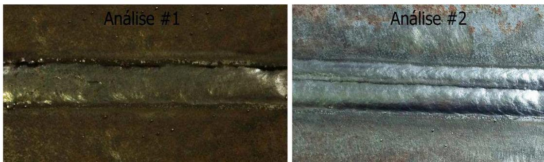
Figura 4.12 – (a) Um passe de acabamento; (b) Dois passes de acabamento.
