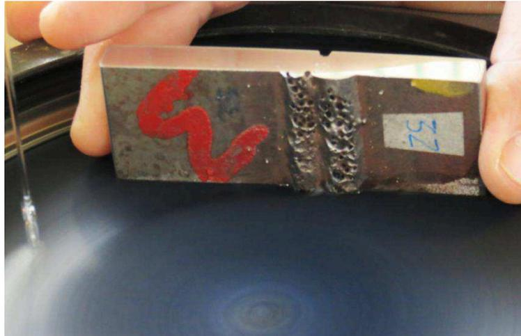
Figura 4.22 – Lixamento do corpo de prova
