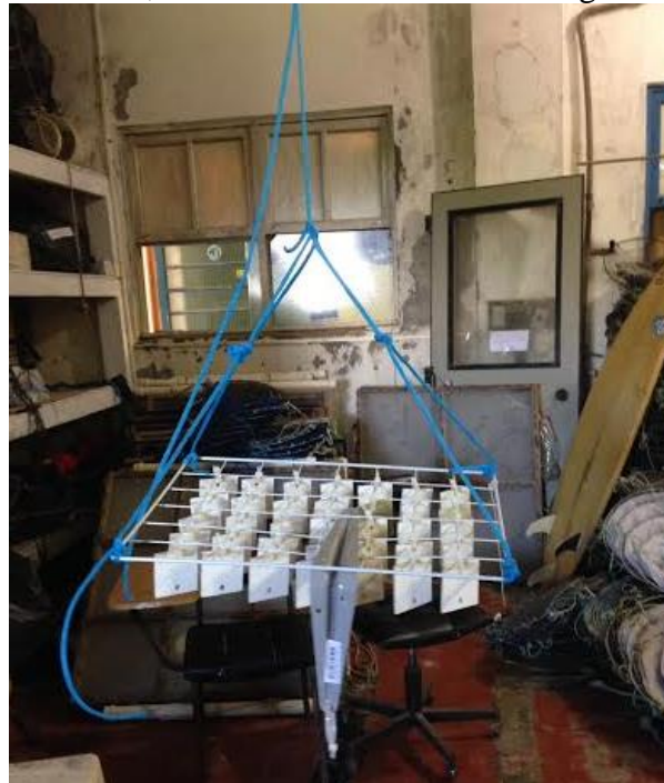
Figura 13 - Imagem da estrutura empregada para a submersão dos corpos de prova em ambiente marinho, evidenciando as amostras na grade metálica.
