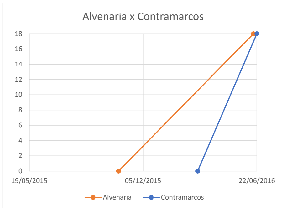
Figura 18 Representação da latência e das diferenças de ritmo de execução de alvenaria e contramarcos.
