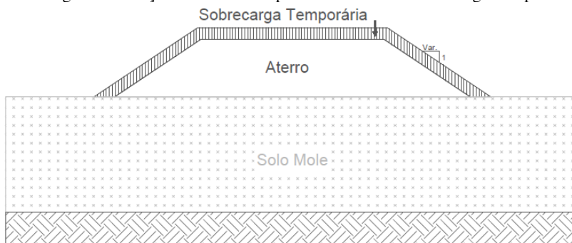
Figura 23 – Seção Transversal Típica de Aterro com Sobrecarga Temporária
