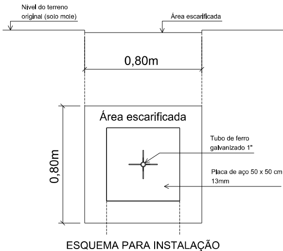
Figura 72 – Detalhe típico de uma placa de recalque
