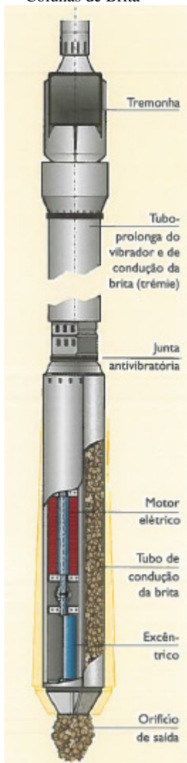
Figura 29 – Detalhes Típicos do Equipamento Utilizado na Execução de Colunas de Brita
